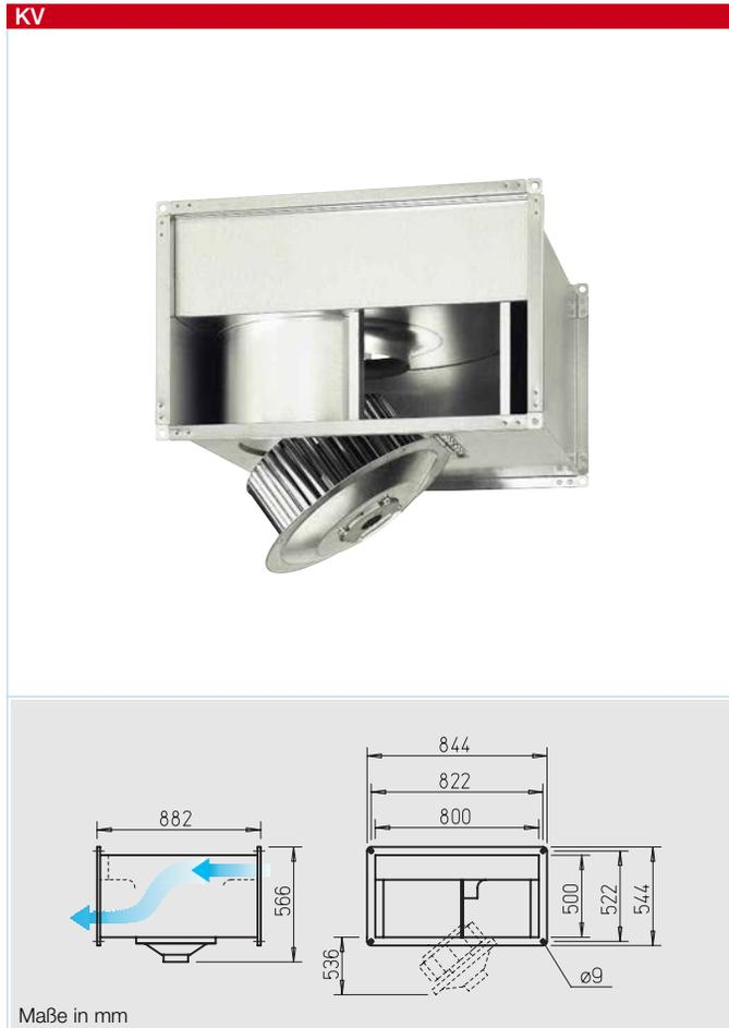
**Radial-Kanalventilatoren mit vorwärts gekrümmten Laufradschaufeln. Motor-Laufradeinheit ausschwenkbar.**
