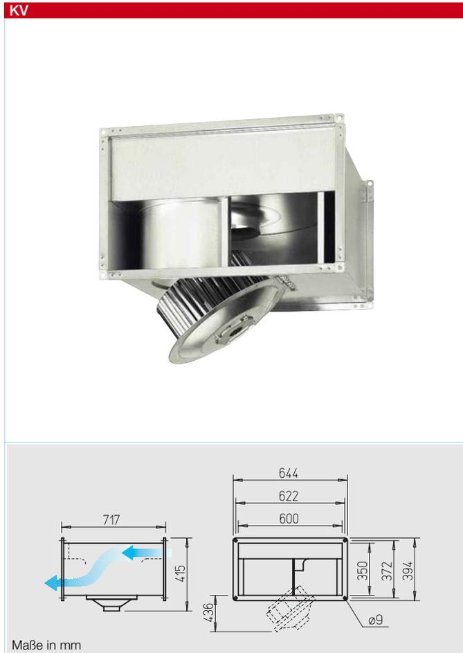
**Radial-Kanalventilatoren mit vorwärts gekrümmten Laufradschaufeln. Motor-Laufradeinheit ausschwenkbar.**
