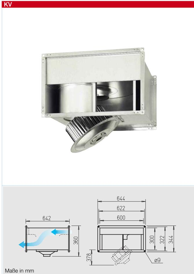
**Radial-Kanalventilatoren mit vorwärts gekrümmten Laufradschaufeln. Motor-Laufradeinheit ausschwenkbar.**
