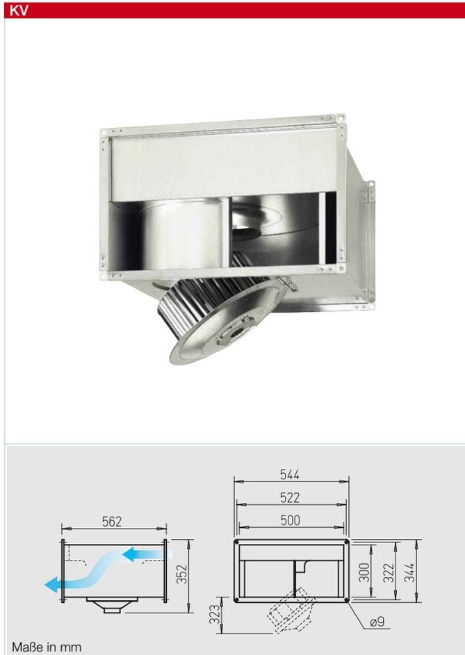
**Radial-Kanalventilatoren mit vorwärts gekrümmten Laufradschaufeln. Motor-Laufradeinheit ausschwenkbar.**
