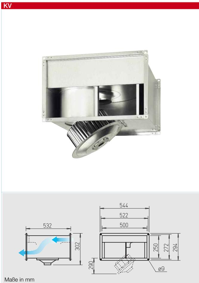
**Radial-Kanalventilatoren mit vorwärts gekrümmten Laufradschaufeln. Motor-Laufradeinheit ausschwenkbar.**
