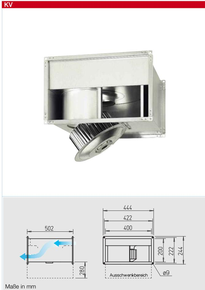
**Radial-Kanalventilatoren mit vorwärts gekrümmten Laufradschaufeln. Motor-Laufradeinheit ausschwenkbar.**
